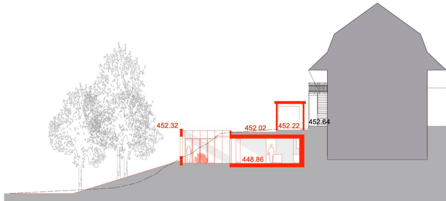
Abbildung 17: Querschnitt mit Beleuchtungssituation im Innern der Wohnung sowie Höhenangaben und Überdeckung für den Bodenaufbau auf dem Flachdach
