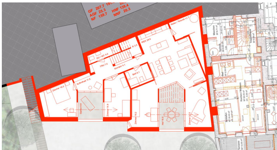
Abbildung 11: Wohnungsgrundriss der 5.5-Zimmer-Wohnung mit Versatz in der Fassadenmauer und zwei Innenhöfen
