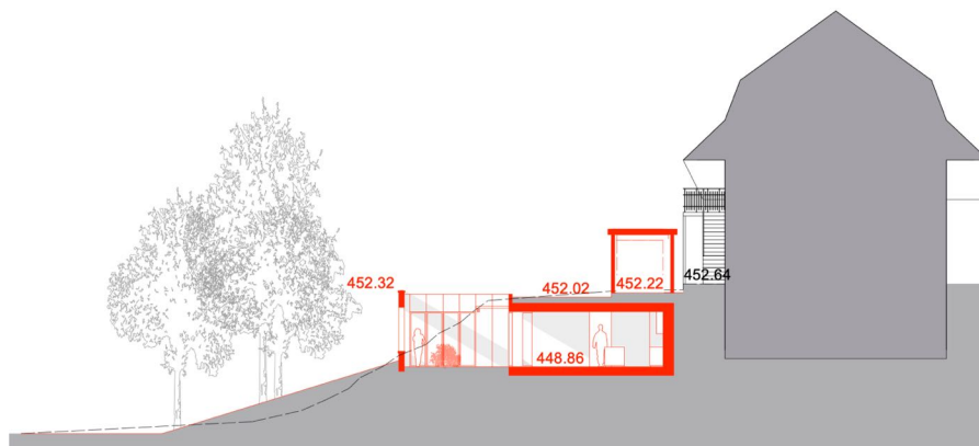
Abbildung 10: Querschnitt mit Beleuchtungssituation im Innern der Wohnung sowie Höhenangaben und Überdeckung für den Bodenaufbau auf dem Flachdach
