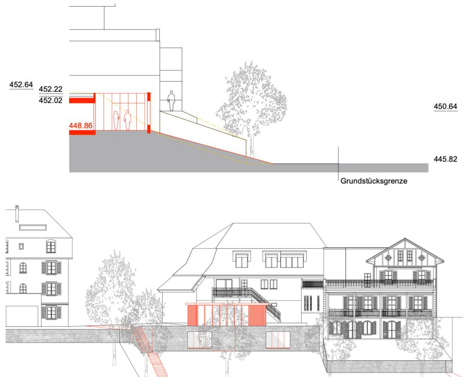
Abbildung 14: Schnitt mit altem und neuem Terrainverlauf sowie Ansicht auf den neuen Terrainverlauf samt Stützmauern
